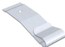
La patte à ressort permet de raccorder les couvre-joints d'une couverture à tasseaux. Elle se visse sur la volige et prévient tout risque de glissement.
