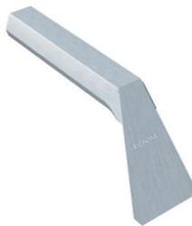
Le couvre-joint de pied est un profilé de finition pour les couvertures en zinc sur tasseaux. Il prolonge le couvre-joint standard en bas de toiture pour assurer l'étanchéité et se fixe par emboîtement sur le rail de fixation. Vissé sur les voliges, il évite tout glissement des bacs.
