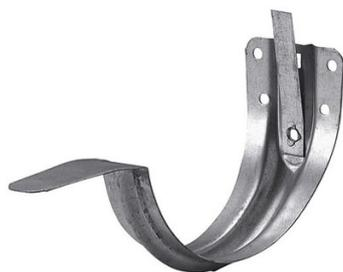
Développé : 250 mm. Boudin : 14 mm. Dos : Plat. Forme : 1/2 rond. Matière : Acier prégalvanisé. Feuillard : 1 mm. Pose : Bandeau. Paillette : Rapportée. Résistance à la corrosion : B. Résistance à la charge : L. Norme : Crochet pour gouttière pendante EN 1462.
