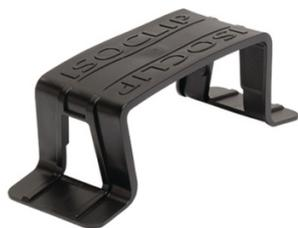
Gain de temps à la pose grâce à la fixation par clouage. lame d'air intermédiaire facilement assurée. Fonction marchepied : sert d'appui pour se déplacer sur le toit.
