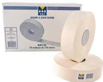
Rouleau de bande de longueur 150 m en papier micro perforé meulé sur une face et rainure au centre pour la réalisation des joints plats ou des angles rentrants des plaques de plâtre.
