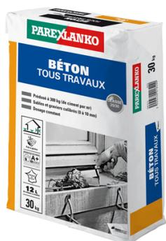
Pré-dosé à 350 kg de ciment par m<sup>3</sup>. Composé de sables et graviers calibrés (de 0 à 10 mm). Recommandé pour la réalisation de poutres, linteaux, poteaux, fondations, dallages. Consommation de 2,5 kg par litre de volume à combler.
