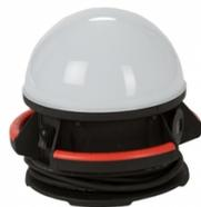
5m de câble H07RNF 3G1.5mm<sup>2</sup>. 2 socles à clapet NF 16A ? 250V. Angle de diffusion : 360°. Interrupteur Marche-Arrêt. Crochet de suspension. Equipé de 3 poignées. Fiche IP44. IK08. Très grande luminosité. Economie d'énergie. Grande durée de vie de la led. Faible dégagement de chaleur.
