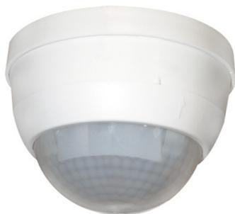
Détecteur de présence spécial couloirs. Un contact NO libre de potentiel pour la commutation. Version appareil Maître. Extension de la portée de détection possible par appareils esclaves. Possibilité de commutation manuelle par bouton-poussoir. D'autres fonctions sont programmables par une télécommande en option. Réglages d'usine 10 min et 500 Lux. Des marquages sont prévus pour l'orientation du détecteur. Domaines d'application : corridors / voies de circulation.
