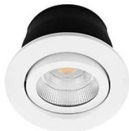
Downlight encastré rond orientable 4 en 1. 2700K, 3000K, 4000K ou 6000K au choix via un interrupteur à l'arrière du luminaire. Fixation par ressorts. Peut être recouvert par un isolant déroulé ou soufflé. Convertisseur dimmable déporté fourni. Compatible avec variateur fin de phase.
