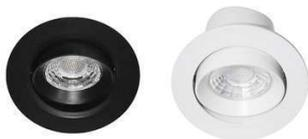
Spot encastré rond orientable dimmable, fixation par ressorts avec double bornier automatique. Peut-être recouvert par un isolant déroulé. Ne nécessite pas de convertisseur. Compatible avec variateur fin de phase. Diamètre de perçement pour insérer le luminaire 75 mm. Orientation verticale possible du luminaire pour un maximum de 30°. Faisceau 60°. Ce produit contient 1 source lumineuse d'efficacité énergétique E. LED remplaçable.
