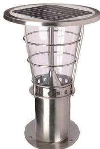
Température de couleur : 4000 K. Faisceau : 120°. Flux lumineux : 250 Lm. Puissance panneau solaire : 3W. Indice de protection : IP65. Batterie : Li-ion 4500 mAh / 6V. Alimentation : panneau solaire. Un interrupteur additionnel permet l'extinction totale de la borne si nécessaire (transport, basses saisons?)
