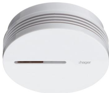
Alimentation : Batterie lithium 3V. Fixation : Vis. Tension d'entrée : 3 V. Zone de détection : 50 m<sup>2</sup>. Autonomie : 10 ans. Niveau sonore du buzzer : 85 dB. Protection : IP32.
