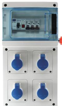
Coffret de chantier de marque Eur'ohm. Fabriqué selon les normes en vigueur. Il est équipé de : 4 prises 2P+T 16 A, 1 arrêt d'urgence, 1 voyant lumineux. 2 disjoncteurs Ph/N 16 A, 1 disjoncteur Ph/N 2 A, 1 interrupteur différentiel 30 mA et 1 arrêt d'urgence.
