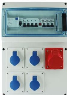
Coffret étanche 14 modules IP65 dim. 440 x 305 x 120 mm. Interrupteur différentiel 4P, 63 A, 30 mA, type AC. Disjoncteur 3P+N, 32 A, 6 kA selon NF EN 60 947-2. 2 disjoncteurs 1P+N, 20 A, 3 kA. Disjoncteur 1P+N, 2 A, 3 kA. Voyant modulaire rouge « présence tension ». Arrêt d'urgence à déverrouillage rotatif. Prise de courant 3P+N+T brochage normalisé CEI 309. 32 A, 400 V, IP 44. 4 prises de courant 2P+T, 16 A, 230 V, IP44. Presse-étoupe M20 x 1,5, IP67, en partie basse. Bornier de terre IP2x.
