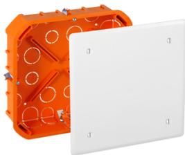
Boite de dérivation avec couvercle à visser. Accepte gaine ICTA D16, D20 et D25, Vis livrées clipsées sous le couvercle.
