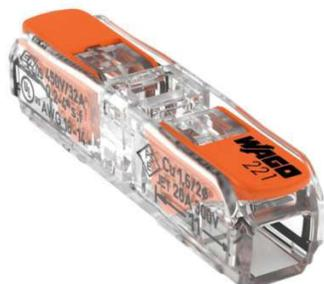
Connexion des conducteurs rigides, semi-rigides et souples de 0,2 à 4 mm<sup>2</sup> dans le sens traversant. Parfaitement adaptée aux espaces restreints grâce à son design fin « Inline ». Raccordement sans outil simple, rapide et sûr. Connection multi-pôles et marquage personnalisable.
