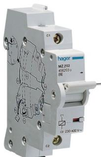
Les bobines à émission (bobines MX) permettent de déclencher mécaniquement un disjoncteur ou un interrupteur différentiel quand la bobine du déclencheur est alimentée en tension.
