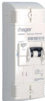
Disjoncteur de branchement Enedis bipolaire, pour tarif à puissance limitée (tarif bleu) permettant la coupure et le sectionnement de l'ensemble de l'installation ainsi que la protection contre les surcharges et les court-circuits
