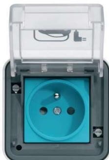
La prise witty est une prise renforcée de la gamme cubiko grise avec un IP55, elle permet la recharge d'un véhicule électrique ou hybride rechargeable jusqu'à 3,7kW soit 16A en fonction des performances du chargeur embarqué sur le câble du véhicule. Elle dispose d'un capot transparent avec le symbole d'un véhicule électrique. Elle permet aussi la recharge de vélo à assistance électrique ou trottinette électrique.
