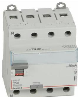
DX<sup>3</sup>-ID interrupteur différentiel modulaire tétrapolaire, détecte les fuites de courant dues à des défauts d'isolement coupe immédiatement l'alimentation du circuit concerné lors d'un contact accidentel avec le courant. Arrivée haute et sortie basse par bornes à vis. Type AC : détecte les défauts à composante alternative. Accepte les auxiliaires, les commandes motorisées et les modules de raccordement DX<sup>3</sup>.
