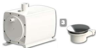
Equipée d'une bonde spécialement développée pour s'adapter sur tous les receveurs standards extra plats (90mm). Faible décaissé et évacuation de diamètre réduit. Débit d'évacuation de 30 l/mn. Tamis à cheveux amovible et nettoyable, pour un entretien quotidien. Module de détection sans fil : permet à la bonde d'activer la pompe à distance pour évacuer l'eau entrante. Module de détection remplaçable pour une maintenance plus facile sur le long terme.
