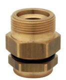
Raccords FLEXICLIC mâle à joint plat gaz. Tuyau FLEXIPIPE annelé en acier inoxydable. Pression maximale d'utilisation du calibre 10 au calibre 25 : 2 bar. Pression maximale d'utilisation du calibre 32 au calibre 50 : 500 mbar.
