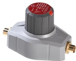
Pression d'entrée : 0,5 - 1,75 bar. Pression de sortie : 37 mbar. Raccordement M 20x1,5. Débit 4 kg/h.
