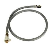
Pression maximale d'autilisation : 37 mbar. Robinet avec obturateur automatique intégré. Tuyau flexible inox annelé renforcé par une tresse en fil d'acier inoxydable, équipé d'?1 joint. Entrée : mâle G 1/2??. Sortie : écrou prisonnier tournant femelle G 1/2?? avec bouchon. Classe de température :  $-5^{\circ}$ C /  $+60^{\circ}$ C.
