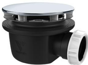
Bonde extra-plate Minime pour receveur de douche de diamètre 90 mm, écrous inclus. Capot ABS chromé de diamètre 117 mm, hauteur 60 mm, sortie horizontale de diamètre 40 mm à visser ou à coller. Dotée d'un joint autofix double, d'une garde d'eau de 30mm, d'une pente intégrée de 2,5° et d'un godet extractible.
