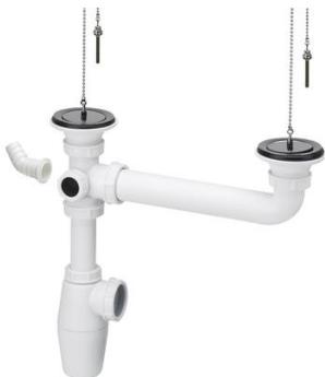
Départ joint conique Ø 40. Garde d'eau 60 mm. Réglable en hauteur. Prise pour machine à laver. 2 bodes plastique blanc à chaînette.
