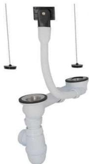
Utilisation : évacuation des eaux usées d'un évier inox à deux bacs. Perçage cuve : Ø 60 mm. Chaînette perlée 28 cm avec piton d'attache. Diamètre de sortie : Ø 40 mm. Prise pour machine à laver. Trop plein. Matière : polypropylène blanc + inox.
