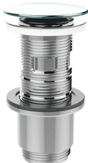
Bonde universelle pour lavabo ou vasque avec lanterne désoperculable. Clapet recouvrant, hauteur totale de 100 mm recoupable, serrage de 5 à 87 mm. Filtre récupérateur pour un entretien facile. Débit de 30 l/mn.
