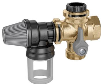
Groupe NF antipollution pour chauffe-eau (max 10 kW) vertical ou horizontal. Avec clapet anti-retour, vanne d'isolement et une soupape en technopolymère avec siège ultra résistant tarée à 7 bar. Adapté pour les eaux calcaires et agressives.
