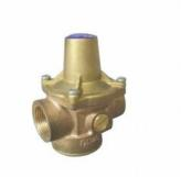
Normalisé NF EN 1567. Fonctionne en toutes positions. Pression amont maxi 16 bar. Pression aval réglable de 1 à 5,5 bar. Préréglé d?usine à 3 bar. Débit 2000 l/h en 15/21, 2800 l/h en 20/27 pour une perte de charge de 1 bar. Bouchon 1/4??de chaque côté permettant la pose d?un manomètre. Corps bronze.
