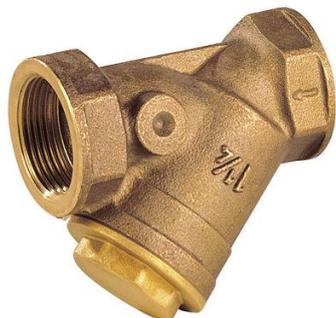
Filtre à tamis bronze pour les réseaux d'adduction et de distribution d'eau. Filtration 400 -500 suivant le DN avec tamis en inox 304. L'étanchéité est assurée par un joint PTFE. Compatible avec les réseaux d'eau potable grâce à l'attestation de conformité sanitaire (ACS).
