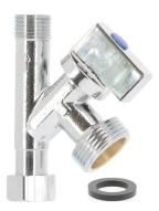
Robinet de piquage pour machine à laver en laiton titré Européen ACS 4MS, avec sortie 3/4" en V pour éviter la casse du flexible, finition chromée et joints EPDM
