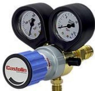
Le manodétendeur TYPHOON oxygène est de type simple détente, à clapet placé dans la haute pression. Robuste et fiable, il est adapté à toutes les applications professionnelles et industrielles. Conforme à la norme EN ISO 2503. Raccord d'entrée bouteille : type F Raccord de sortie : M16x150 Droite Fourni avec une olive étagée pour tuyaux Ø6,3 et Ø10mm. Débit max. : 30 m<sup>3</sup>/h à 6 bar.
