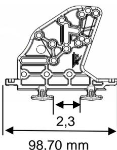
Les supports PVC de type HP et HK couvrent la plupart des cas de pose. Ils se fixent sur le coté de la fermette ou du chevron par 3 vis type VBAØ 4 longueur 40 mm minimum.
