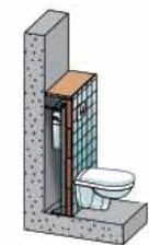
Installation sur mur porteur
